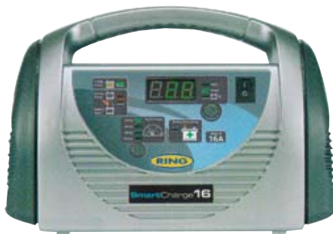
RESC16 Akkulaturi 12 V 2/16 A Täysautomaattinen älylaturi sis. tuulettimella. Akkutesteri, elvytyslataus, näyttää jännitteen ja ampeerit, vääränap. suoja, IP20
